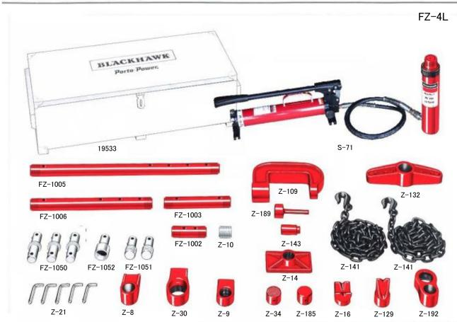
ボートパワー ゼネラル リペヤー 10トンセット - 大きな修理作業や自動車修理全般 の為にデザインされたセットです。トラックのサービスセンターや機耕機修理業 者には欠かせぬものです。評判の良いアタッチメント類、チェーン、それにZ - 132 ブルカラーが揃っており、引き作業が簡単に出来ます。持ち運び自在 "C" クラン ブはボータブルプレスとして、お忙しいあなたのお店の人気者になります。 この 10トンセットに組み込まれた種々のアタッチメント類を使用して、押し作業、拡 げ作業、引き作業、プレス作業にと、存分に能率をおあげ下さい。頑丈な木箱に 入っています。
