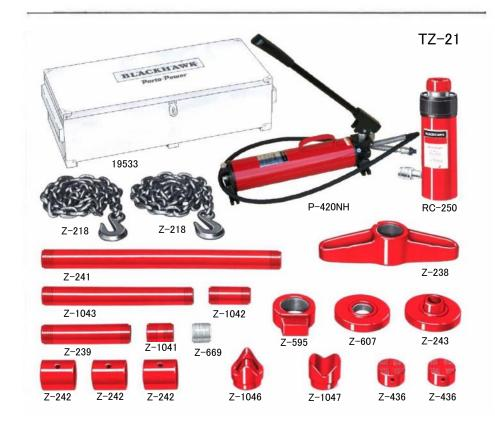
TZ - 21 ポートパワー デラック ス 20トンセット 一アタッチメン トを種々組合せて広範囲にご使 用いたゞける20トンの力をもっ たセットです。P - 420自動切換 2 スピードのポンプはラムを繋 早く作動させます。またZ-607 プランジャーベースとZ-595ト ウリフトで拡げ作業が出来ます。 Z - 238プル カラーとチェーンと を使って大きな機械や大きな部 分の引き作業にお使い下さい。 このセットは大修理作業の為の 強力セットですので、大がトり な修理作業も簡単に出来ます。 格納に便利な木箱がついており ます。
