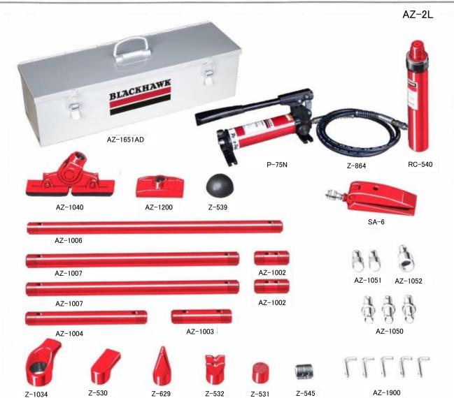
デラックス ポートパワー パンタムセットーボデー修理作業に高能率を発揮する組合せとなっています。強力な 4トン油圧ユニットを土台としたこのセットにはご存知のSA・6ウェッジラムが、狭い所の拡げ作業に、又Z・530とZ・1034スプレッダートウが部分拡げ作業に、この他、用途の広いAZ・1040ワイドアングルウェッジへッドで、あなたの例望みの所にぴったりとつけて、圧力をかけ矯正する押し作業に一デラックスなアタッチメント類が組込まれております。この便利なセットは仕切箱のついたメタルケースに入っております。工具を常に綺麗にしておく事が出来、傷をつけたり、紛失したりすることがなくなります。セット内容は上図をご覧下さい。
