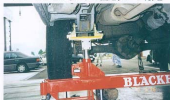
サスペンションリンクの固定(パーツ付)③
