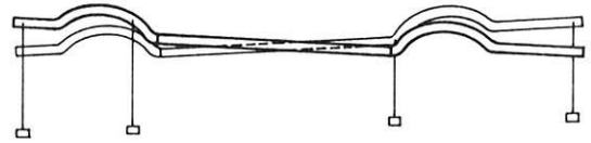
ツイストを起した車のフレームは横から見る と僅かにX字形にねじれています。
