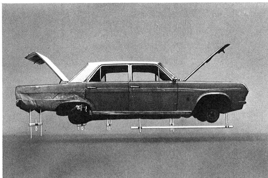
タイヤハウジングにかけたゲージが高くなっています。
